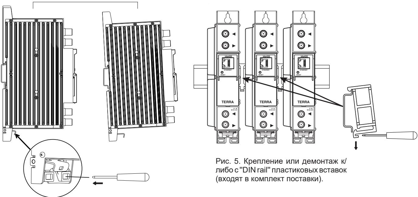
Рис. 5. Крепление или демонтаж к/либо с "DIN rail" пластиковых вставок (входят в комплект поставки).
