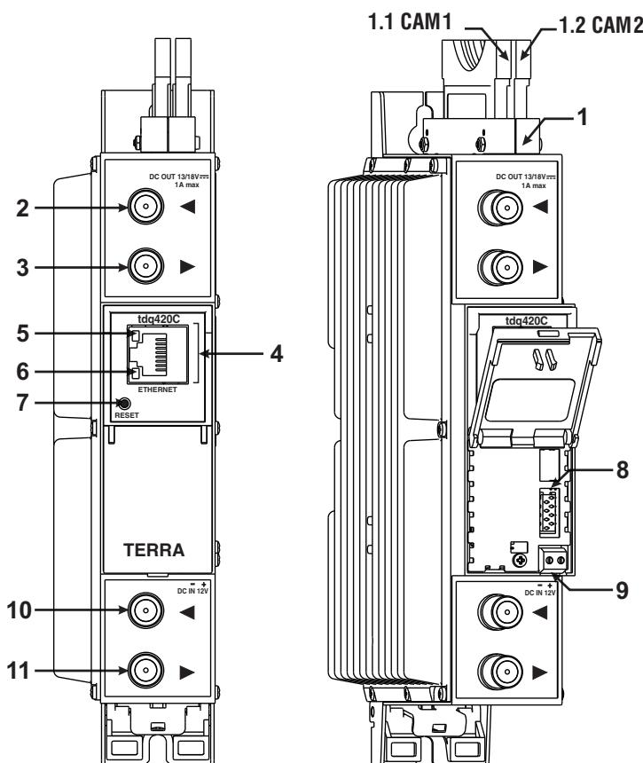
1 - Два PCMCIA гнезда для установки модулей условного доступа (tdq420C, ttq420C).
