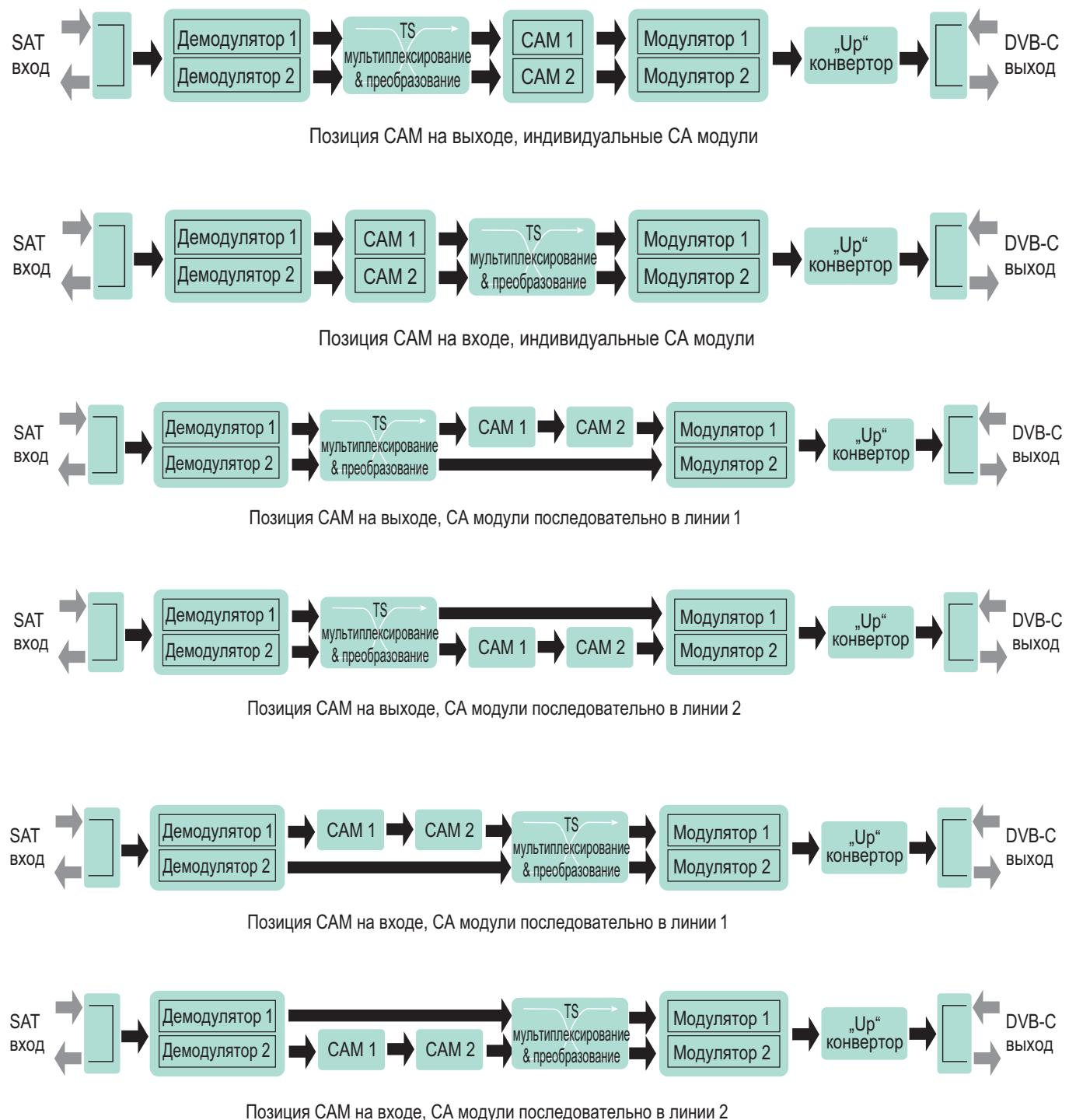
Рис. 32. Конфигурирование модулей условного доступа
